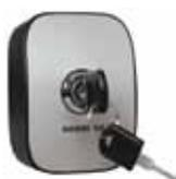
Ключ-кнопка Keyswitch используется для подачи команды на блок управления приводом для открывания, остановки или закрывания ворот. Для подачи управляющей команды нужно повернуть ключ, под действием пружины он вернется в исходное положение. Каждый поворот ключа соответствует одной команде по принципу «открыть» – «стоп» – «закрывать» – «стоп». Ключ-кнопка имеет механическую блокировку, которая не позволяет снимать крышку без установленного и повернутого ключа.
