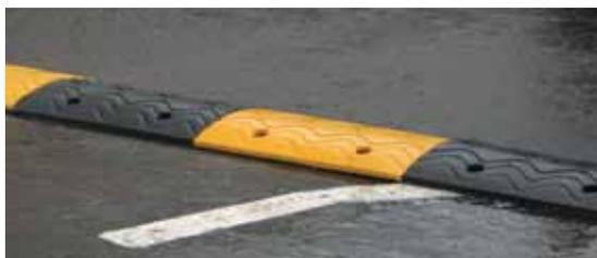
Предназначен для ограничения скорости транспорта, а также уменьшения светового проема между полотнами ворот/калиток и землей. Изготавливается из износостойкого искусственного каучука. При установке «лежачего полицейского» не требуется штробление дорожного покрытия для прокладки электропроводки между столбами.
